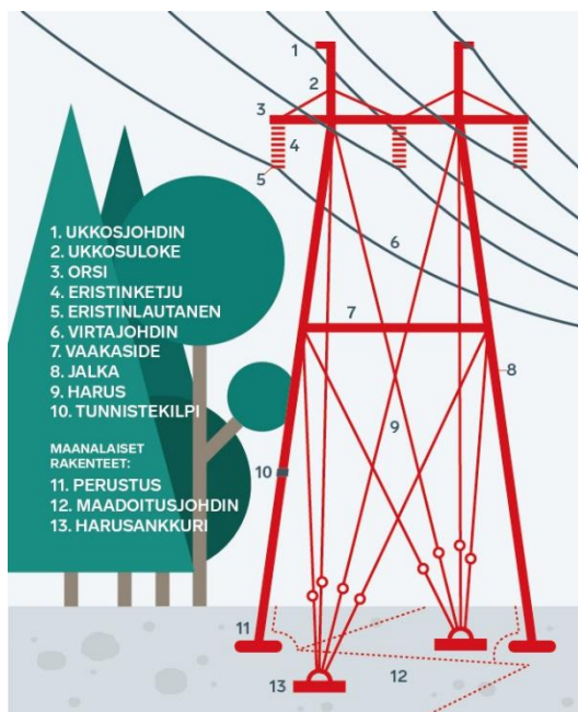
Kuva 5-7. Voimajohdon osat (Fingrid 2020).
