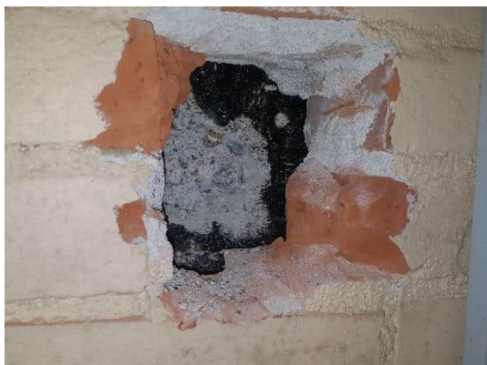
Kuva 73. Näyte kellarin sivelestä (PAH3), ei sisällä PAH-yhdisteitä yli haitallisen määrän raja-arvon.
