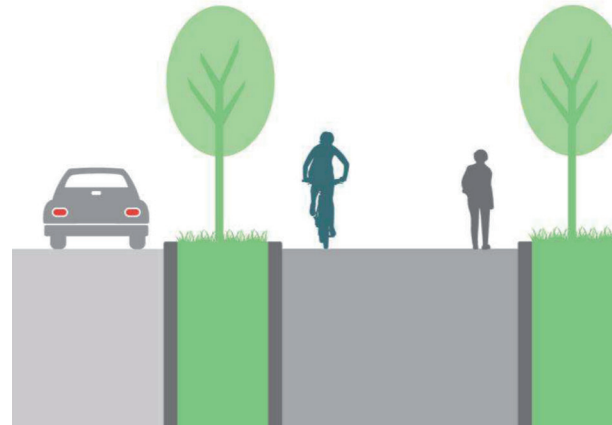
Yhdistetty pyörätie ja jalkakäytävä erotettuna ajoradasta puurivillä.
